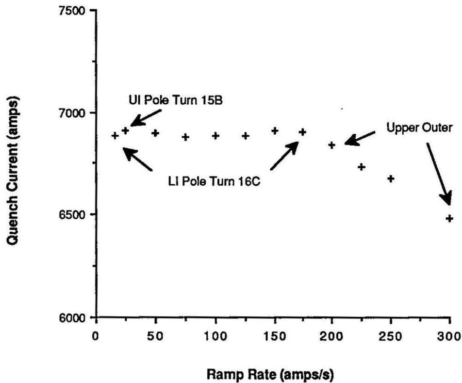
Fig. 4 DS0315 and DS0311 Ramp Rate Comparison
