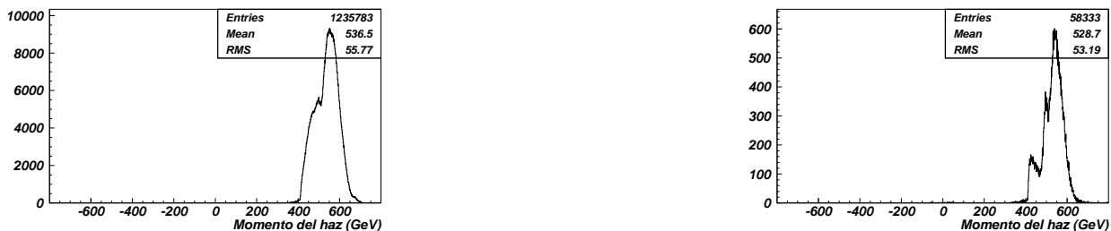
Figura 5.189: Distribución de momento del haz primario. Izquierda: bariones. Derecha: mesones (pos 570 Be).
