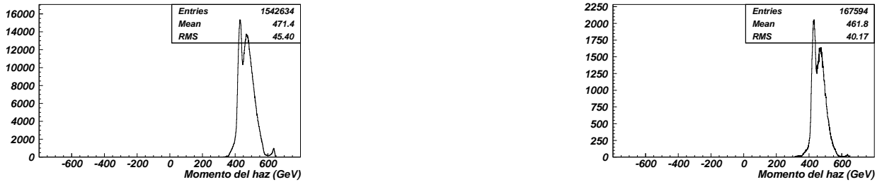
Figura 5.282: Distribución de momento del haz primario. Izquierda: bariones. Derecha: mesones (pos 500 C).
