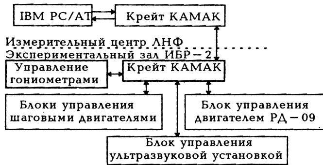
Рис.3. Блок – схема измерительно – вычислительной системы установки ДИФРАН
