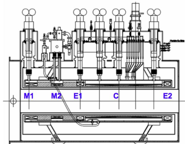
Fig. 2. Spectrometer Solenoid.
